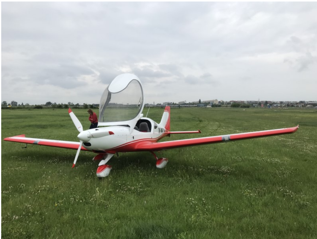
Obr. 9 - UL letoun po dojezdu, viditelné jsou vyjeté koleje v travnatém porostu po jeho dosednutí
